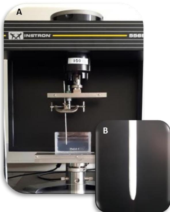
**Figure 26 : Représentation d'un test de pénétration réalisé pour la caractérisation de la résistance mécanique des milieux de culture une-couche et deux-couche**
