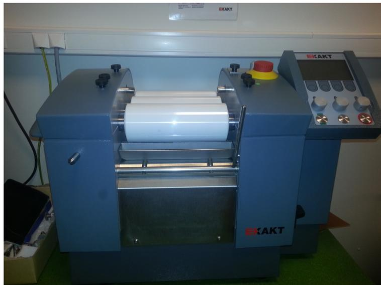
FIGURE 1.6 – Mélangeur tricylindre
