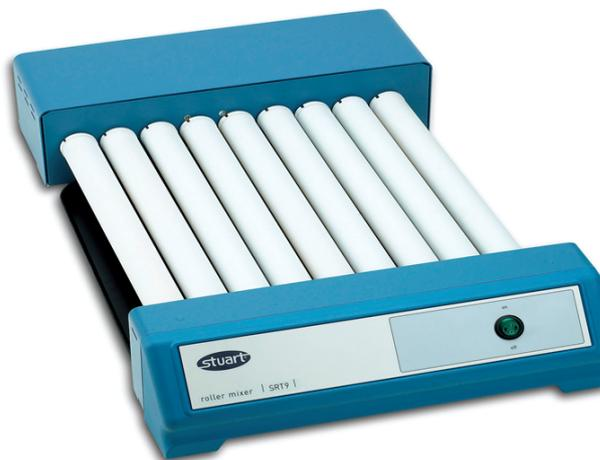
FIGURE 2.3 – Agitateur à rouleaux pour la conservation des encres
