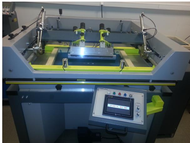
FIGURE 1.7 – Sérigraphieuse semi-automatique
