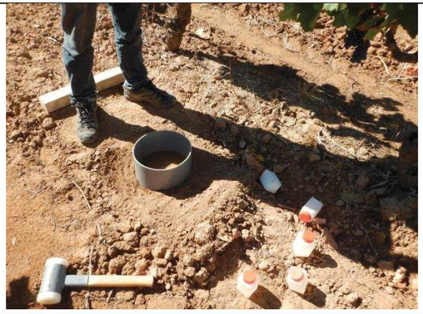
Mise en place du test d'infiltration 2
