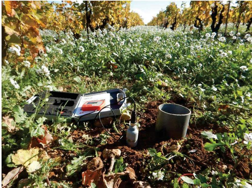
**Figure 3-11: Photo prise sur le terrain de l'Orbieu montrant le dispositif de test de Beerkan et de mesure de l'humidité à saturation du sol.**
