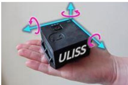
Figure 57 : Centrale inertielle et magnétique ULISS
