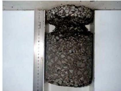
Figure I. 13 Les éprouvettes carottées sur les chaussées dégradées avec les nids de poules [2]
