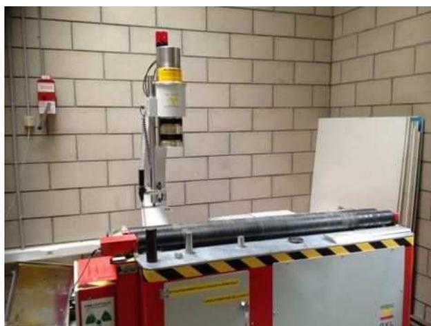
Figure II. 3 : Banc gamma densimétrique
