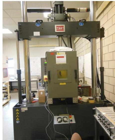
(b) Presse MTS pour l'essai TSRST
