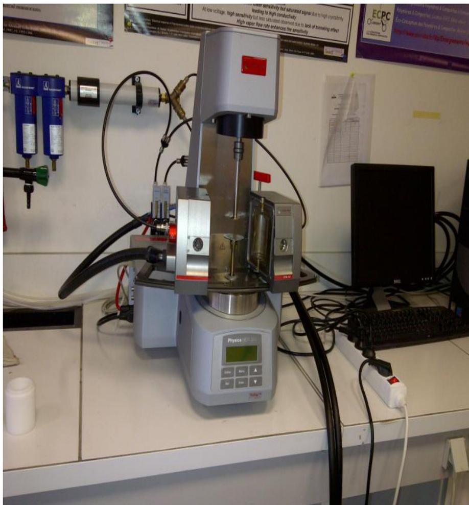
**Figure II.10** : Image d'un rhéomètre de type Anton Paar MCR 301.
