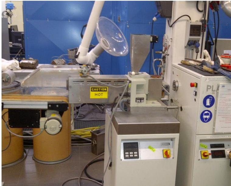
**Figure II.6** : Extrudeuse mono-vis Brabender OHG Duisburg-Allemagne.
