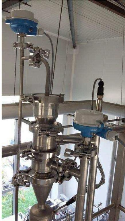
Figure 43 : Le système de récupération des dépôts installé en tête du faisceau F3
