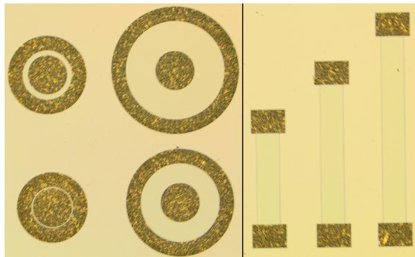
FIGURE 2.4 – Photographie d'échantillons. À gauche des corbinos et à droite des barres de Hall.
