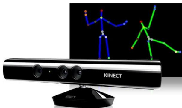
FIGURE 3.3 – Caméra de profondeur Microsoft Kinect<sup>TM</sup> pour la capture et l'analyse du mouvement
