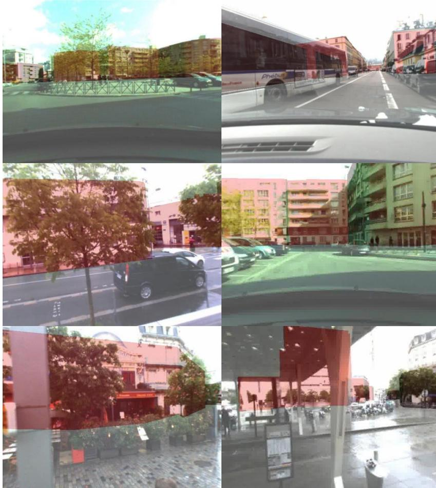
FIGURE 4.24 – Exemples de projections de modèles  $3d$  (en rouge), en utilisant la pose des caméras estimées par notre méthode. Nous soulignons le fait que les hauteurs des modèles  $3d$  des bâtiment sont imprécises, et que leur erreur horizontale maximale est d'environ  $2.5m$ .
