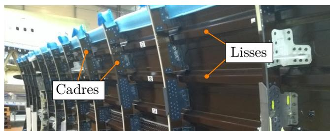
FIGURE 7.2 – Cadres et lisses d'un panneau latéral d'A350.
