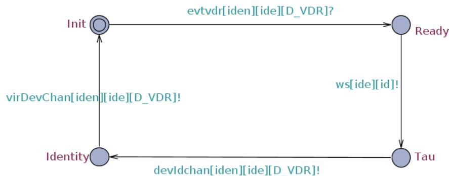
Cet automate fait appel à d'autres composants (VirtualDevice et DevId) par l'émission sur les canaux *virDevChan* et *devIdchan*.
