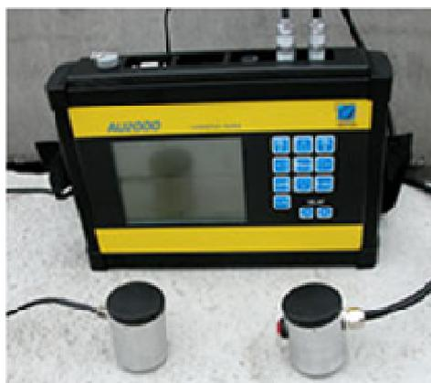
Figure II-25 : Appareil ultrasonique AU 2000
