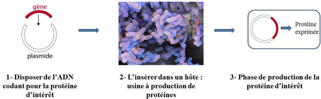
Schéma 35. Principe de la production de protéine recombinante.
