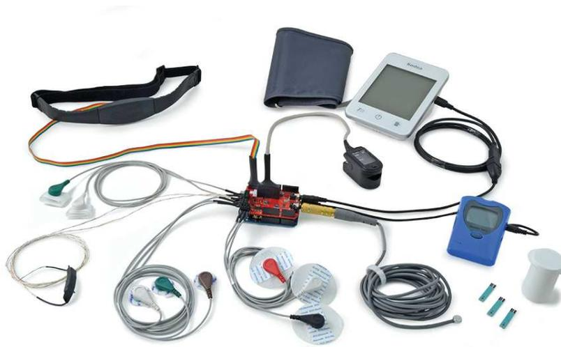
Figure 3.18: Shield e-Health et ses capteurs
