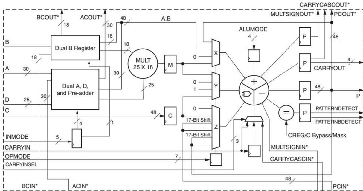
Figure 5.1 Virtex-6 FPGA DSP48E1 Slice [81]
