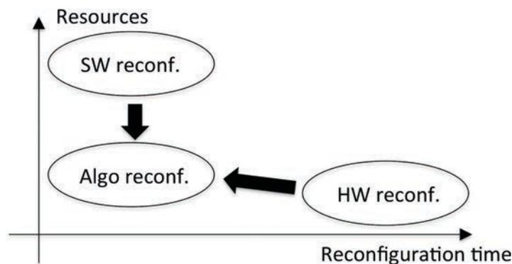
Figure 2 - Compromis ressources utilisées et temps de reconfiguration pour les différents types de reconfiguration.
