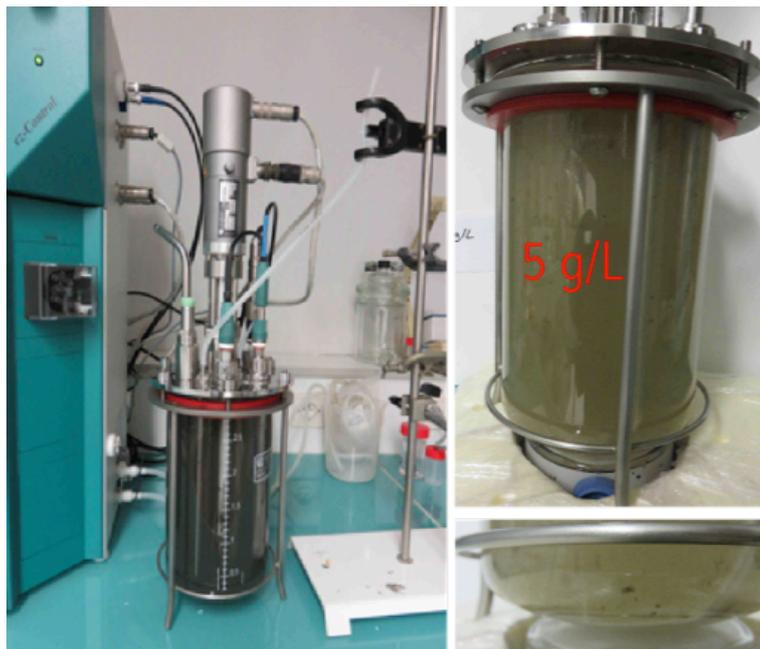
Figure III-7: Bioréacteur pendant une expérience de resuspension.
