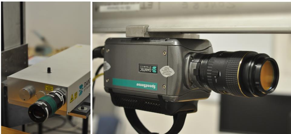
FIGURE 3.16 – Photographie du laser double-tête (gauche) et de la camera CCD (droite)
