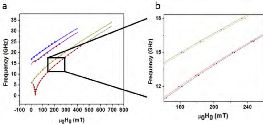
Figure 14: a) relation de dispersion  $F_{\text{res}}$  vs.  $\mu_0 H_0$  pour l'échantillon de référence pour un champ appliqué dans le plan de la couche. A droite, zoom sur les deux modes délimitées par la boîte noire en a).
