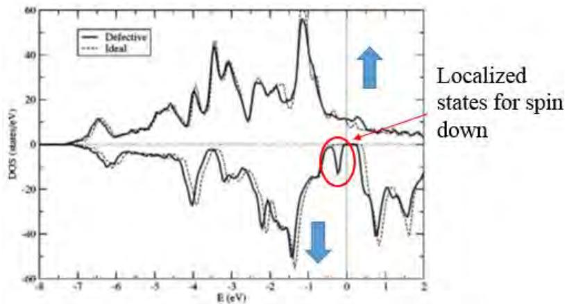
Figure 19: Densité d'états résolues en spins pour une structure idéale (L2<sub>1</sub>) et une structure comprenant un désordre de type Co / Mn qui est typique pour l'ordre D0<sub>3</sub>.
