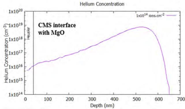
Figure 3-a: concentration d'Hélium en fonction de la profondeur.
