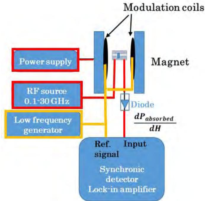
Figure 11: illustration schématique de la configuration FMR.
