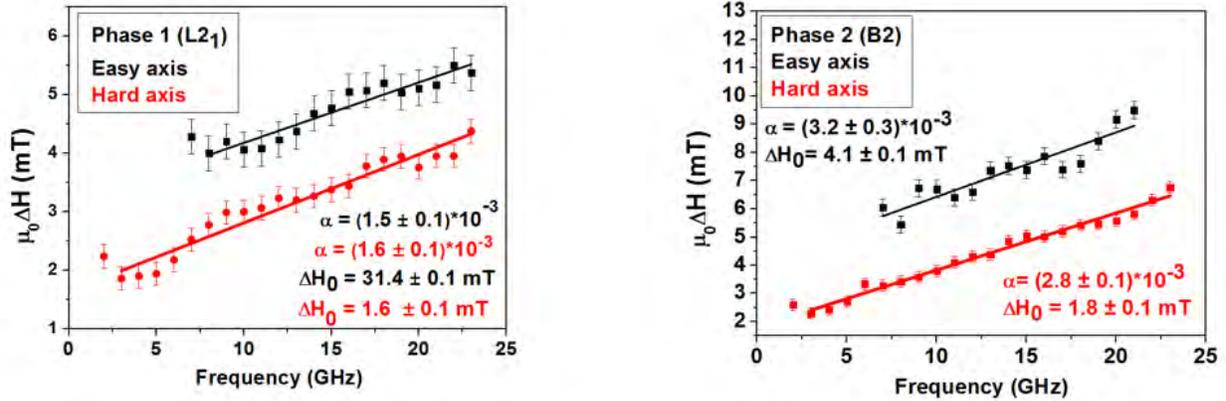
Figure 22 : Largeur de raie en fonction de la fréquence pour un champ appliqué le long des axes faciles et difficiles pour les deux phases observée L2<sub>1</sub> (gauche) et B2 (droite) pour l'échantillon de référence.
