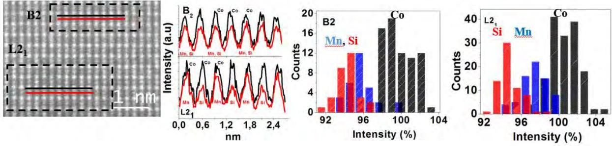
Figure 10: Image STEM-HAADF sur l'échantillon irradié à 1016 ions/cm<sup>2</sup>. Les statistiques ont été effectuées sur les colonnes atomiques délimitées par les zones entourées en a).
