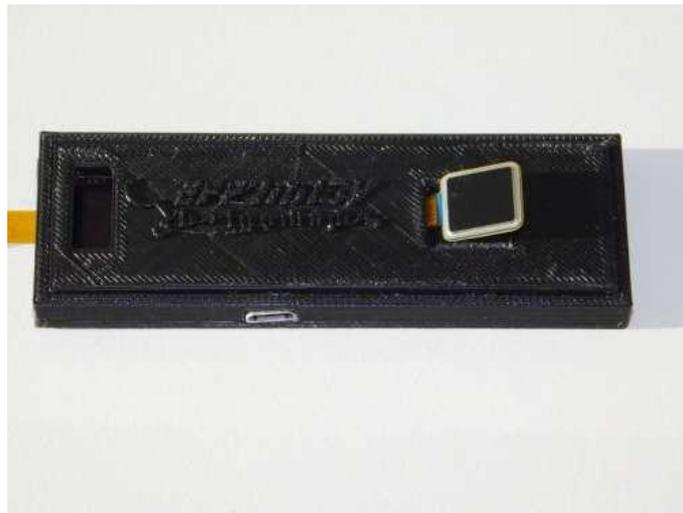
FIGURE 3.10 – Illustration du système sous test, il est possible de distinguer le capteur d’empreinte émergeant à la surface du boîtier, un écran est visible sur la gauche de l’appareil. L’ouïe pour le microphone se situe au dos de l’appareil est n’est par conséquent pas visible.
