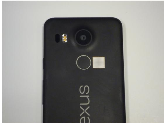
FIGURE 3.4 – Capteur du système B avec un témoin millimétré de 1 cm de coté.
