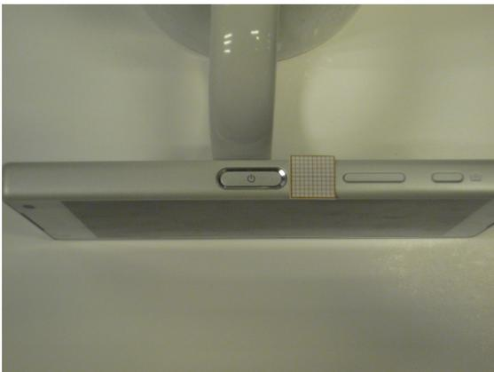
FIGURE 3.5 – Capteur du système C avec un témoin millimétré de 1 cm de coté.
