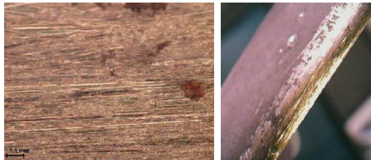
Fig. 101: Lame en bronze 1 « bis » (avec diasporite et eau) X5DF (image de gauche) et X10 (image de droite) à T4 (© N. Thomas).
