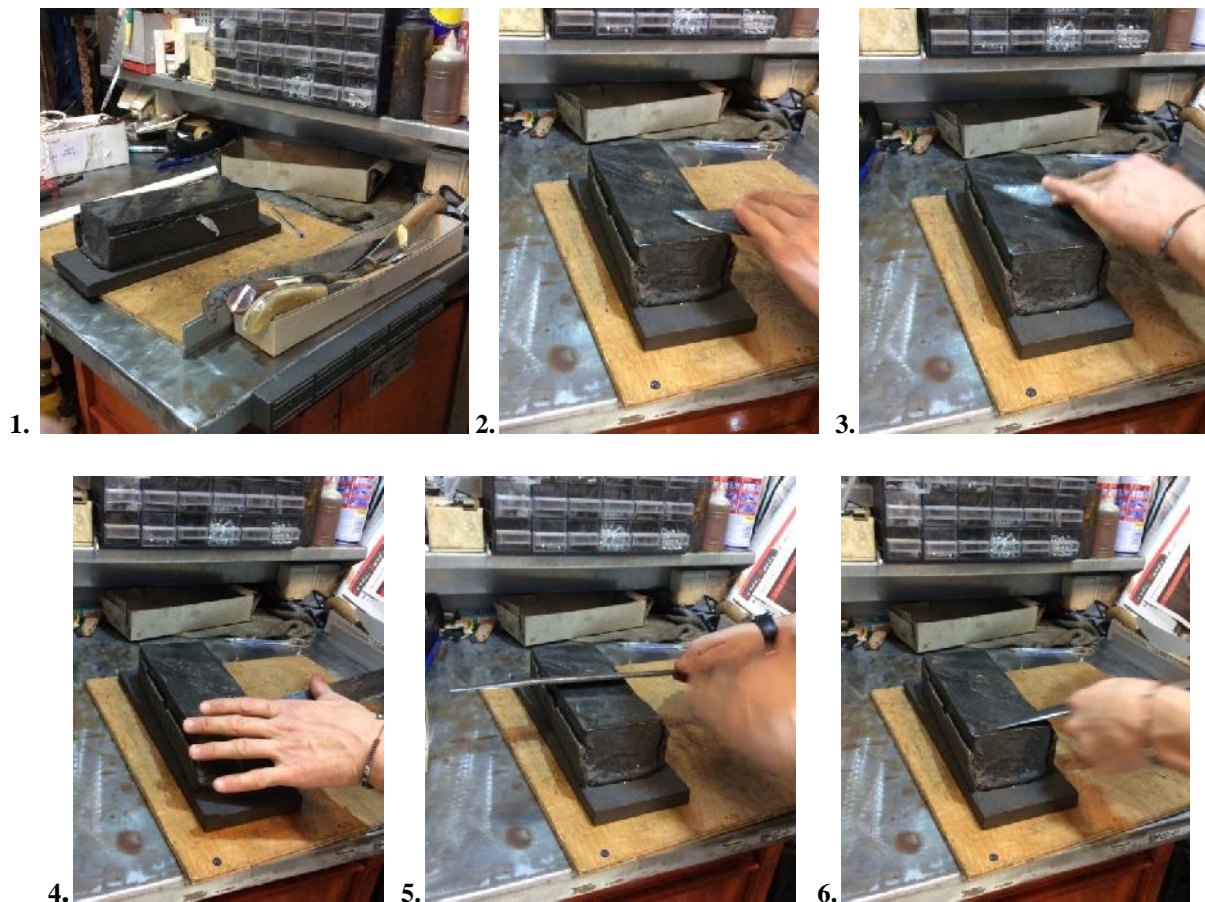
Fig. 65: Actions d'affûtage d'un couteau (lame de grand format) par un coutelier crétois spécialisé - Coutellerie Skalidakis (Chania, Crète occidentale - Grèce) avec la pierre crétoise d'Elounda (employée avec de l'huile d'olive) 92 (© N. Thomas).
