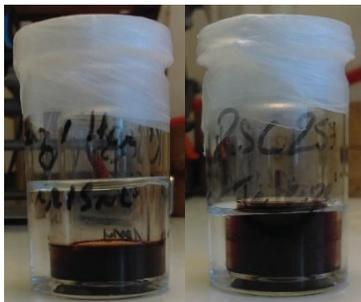
Figure 2.3. Pilulier utilisé lors de la cristallisation par diffusion de vapeur
