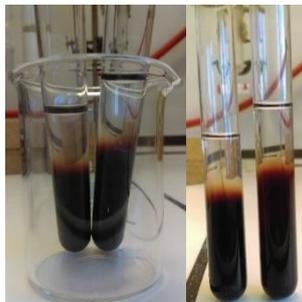
**Figure 2.2.** Tubes à hémolyse utilisés par la cristallisation par diffusion liquide
