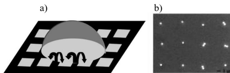
**Figure 4.10 :** a) Evaporation d'une goutte reposant sur un échantillon comportant des zones hydrophobes et hydrophiles, b) Assemblage de particules uniques<sup>95</sup>.
