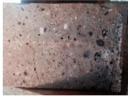
Figure 77 A gauche : sur-cuisson (overfiring) de briques ayant entraîné des fusions partielles. A droite : phénomène de gonflement (bloating) lié à de la matière organique ou des sulfates en excès. Ce sont des défauts connus sur les briques argileuses, et introduits dans les contrôles qualité des industries de la construction ([Defects Bricks Identification - TheConstructor.org](http://DefectsBricksIdentification-TheConstructor.org))
