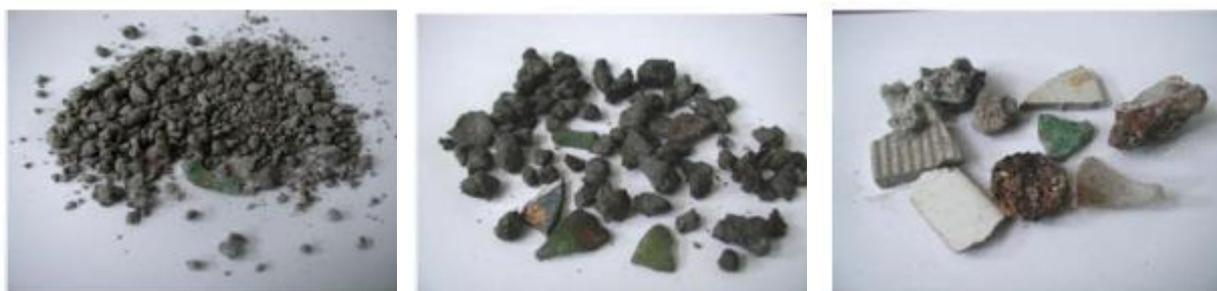
Figure 39 Fractions 0-6, 6-12,5 et 12,5-20mm de mâchefer (Becquart et al. 2009)
