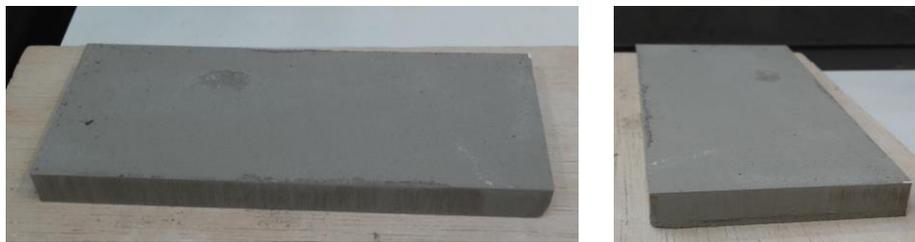
*Figure 70 Corps vert, échantillon E01 (poudre de mâchefer <100µm)*
