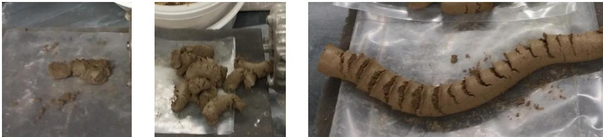
Figure 85 De gauche à droite : corps verts extrudés à 20%ms, 30%ms et 40%ms, sans plastifiant ni lubrifiant
