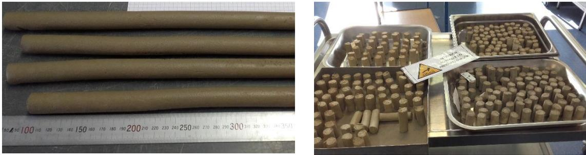
Figure 89 Cylindres extrudés crus (40%ms d'argile), et lots d'échantillons secs
