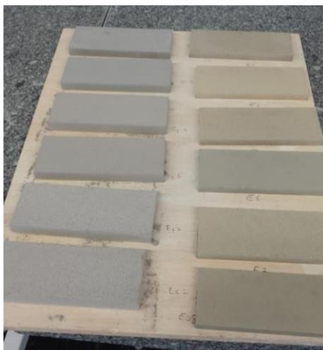
Figure 71 Corps verts. A gauche : plaquettes de mâchefer brut, en duplicats (de haut en bas : <100, <300, <500  $\mu\text{m}$ ). A droite : corps verts contenant de l'argile. On remarque l'état des arrêtes, moins nettes pour les pièces issues de mâchefer seul, effet d'autant plus marqué que la granulométrie des poudres de mâchefer est élevée.
