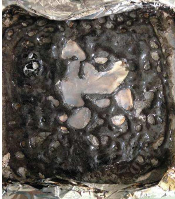
Figure E-46: Résidu de combustion d'un composite EVA/FUI3 (30 %)
