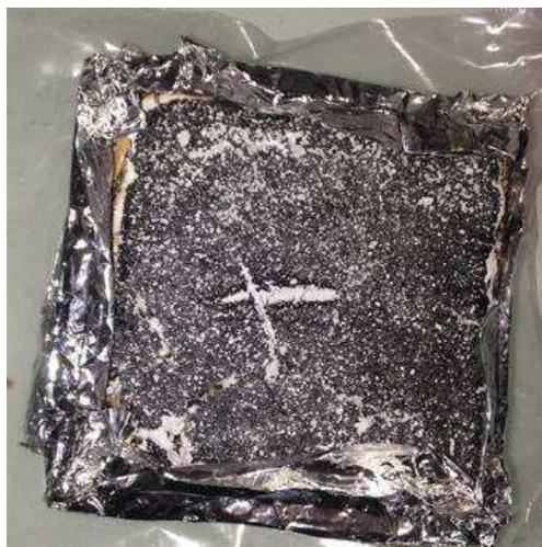
Figure E-54: Résidu de combustion d'un système cœur-peau EVA/ATH (4 mm)-EVA/FUI3 60 % (film)
