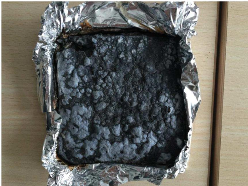
Figure E-32: Résidu de cône calorimètre d'un composite EVA/MDH/Colémanite
