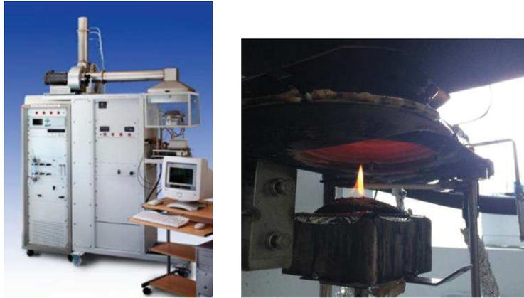
Figure B-26: Cône calorimètre
