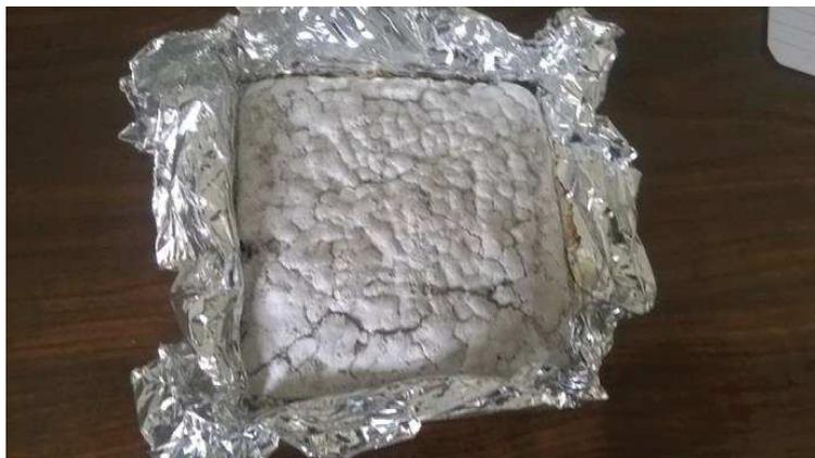
Figure E-38: Résidu de combustion d'un composite EMA/MDH
