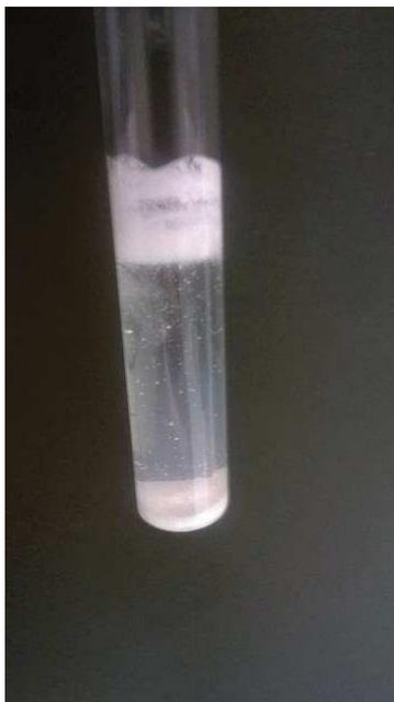
Figure F-10: Visuel de l'essai de sédimentation de la charge traitée au p(MMA-co-MAPC1(OH)<sub>2</sub>)
