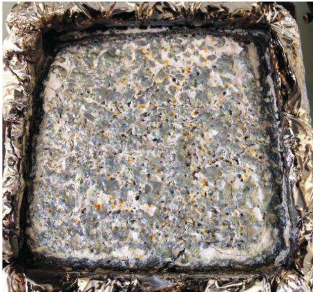
Figure E-52: Résidu de combustion d'un système cœur-peau EVA/ATH (4 mm)-EVA/FUI11 60 % (1,5 mm)
