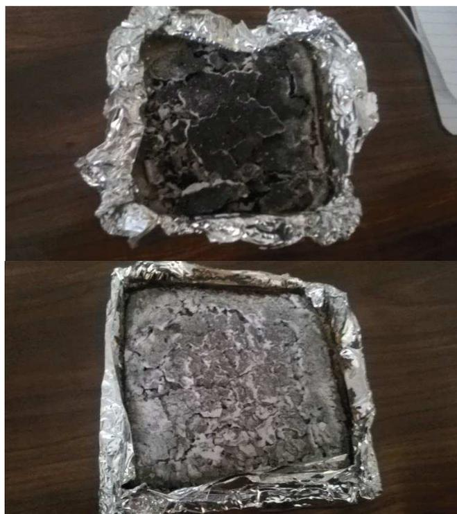
Figure E-57: Résidus de combustion de composites avec dépôt de poudre (FUI3 en haut et Colémanite en bas)
