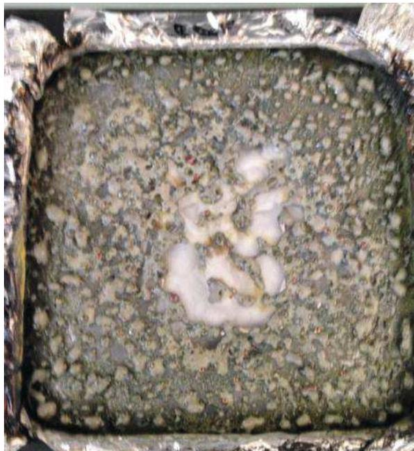
Figure E-47: Résidu de combustion d'un composite EVA/FUI11 (60 %)
