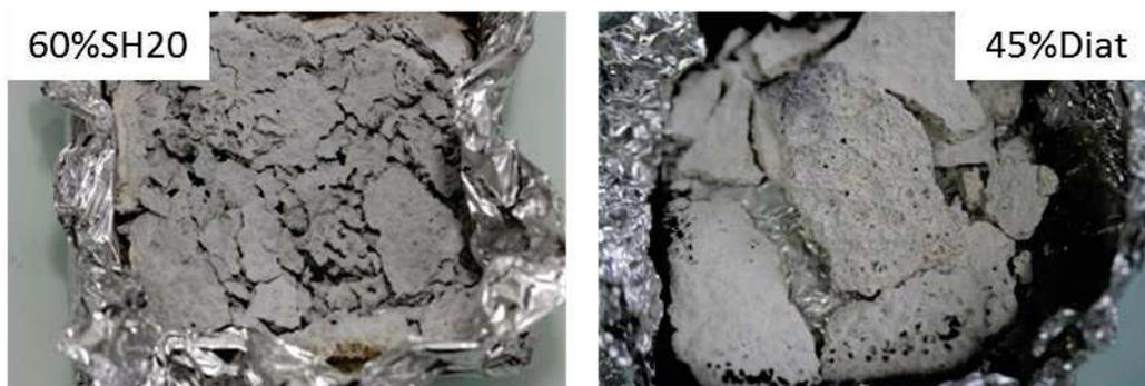
Figure D-9: Résidus des essais au cône calorimètre des échantillons 60%SH20 et 45%Diat
