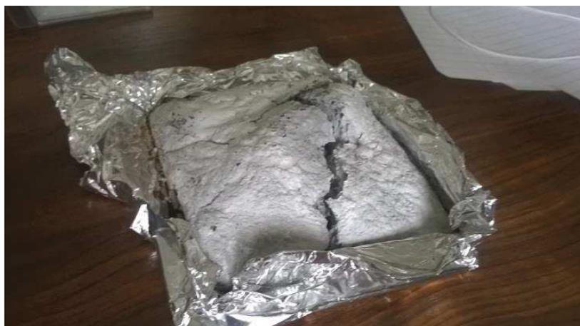
Figure E-36: Résidu de combustion d'un composite EMA/30%ATH/30%Col
