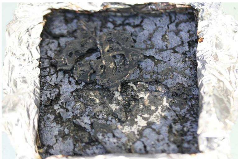
Figure E-29: Résidu de cône calorimètre d'un composite EVA/MDH (60 wt%)
