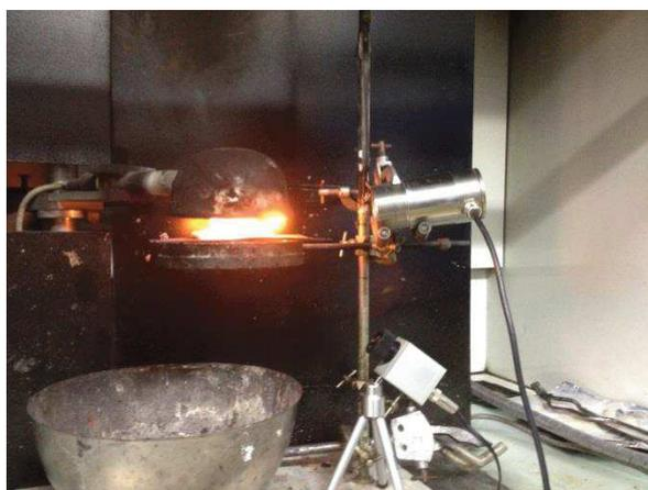
Figure B-28: Montage d'un essai à l'épiradiateur instrumenté
