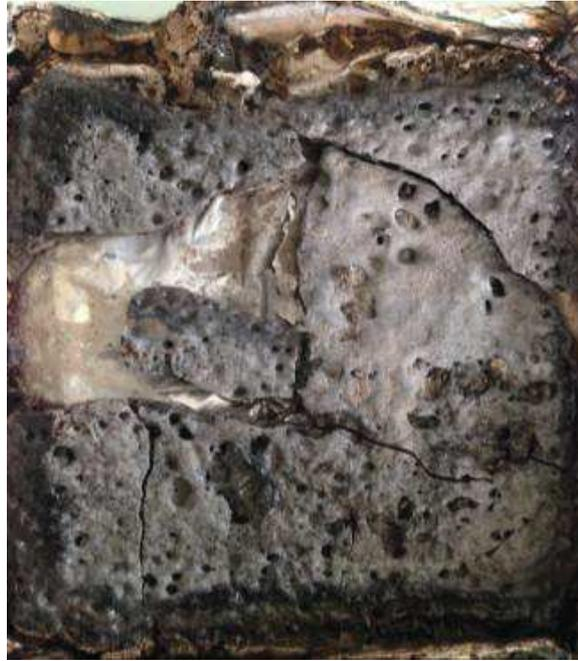
Figure E-44: Résidu de combustion d'un composite EVA/FUI3 (60 %)
