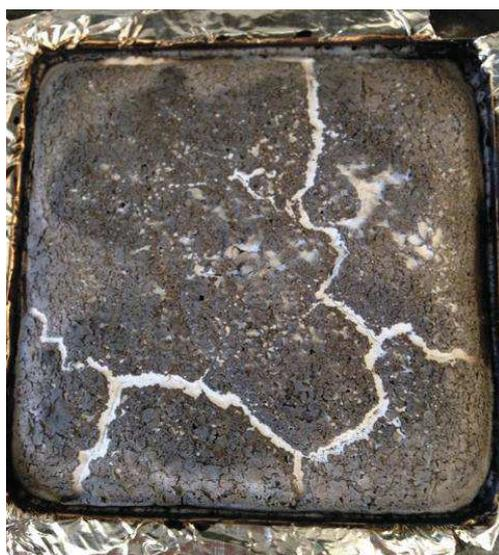
Figure E-55: Résidu de combustion d'un système cœur-peau EVA/ATH (4 mm)-EVA/colémanite 60 % (film)
