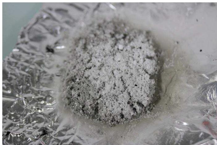
Figure E-19: Aspect d'un mélange 50/50 de colémanite/ATH après chauffage
