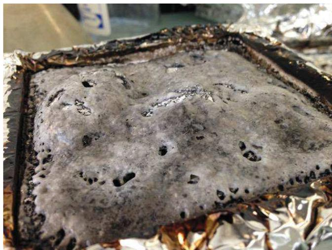
Figure E-50: Résidu de combustion d'un système cœur-peau EVA/ATH (4 mm)-EVA/FUI3 60 % (1,5 mm)
