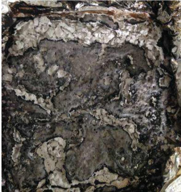
Figure E-51 : Résidu de combustion d'un système cœur-peau EVA/ATH (4 mm)-EVA/FUI3 30 % (1,5 mm)
