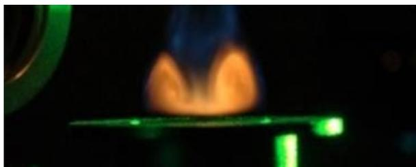
Figure 3-38 – Mise en évidence de la zone de recirculation en sortie du brûleur
