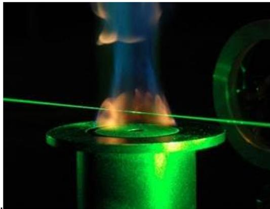
Figure 3-42 – Position du faisceau laser dans la flamme bluff-body ( $z= 12$  mm)
