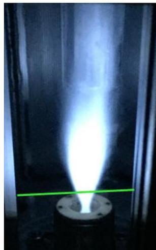
Figure 4-42 – Photographie d'une oxyflamme avec la position du faisceau laser
