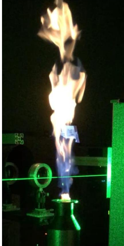
Figure 3-39 – Photographie de la flamme bluff-body complète (faisceau laser à  $z=90\text{mm}$ )
