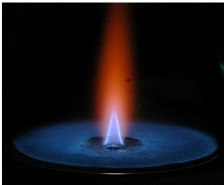
Figure 3-65 – Photographie de la flamme diphasique de gouttelettes d'éthanol avec flamme de garde  $\text{CH}_4/\text{air}$  discoïde
