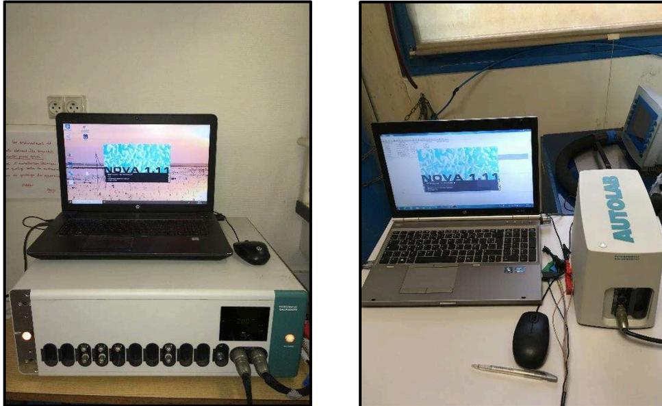
**Figure C.9 :** Potentiostats de la marque AUTOLAB modèles PGSTAT302 (gauche) et PGSTAT204 (droite) utilisant l'interface NOVA 1.11.
