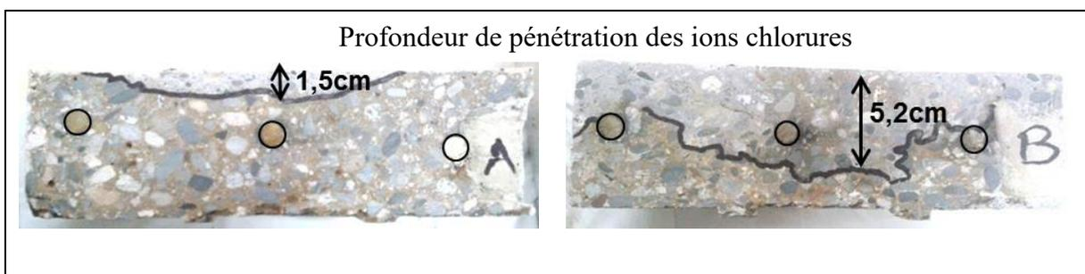
**Figure III-11** : Photos des éprouvettes A (diffusion/absorption) et B (diffusion/absorption/migration) après l'essai de migration de chlorure, sciage et pulvérisation d'une solution d' $\text{AgNO}_3$ .
