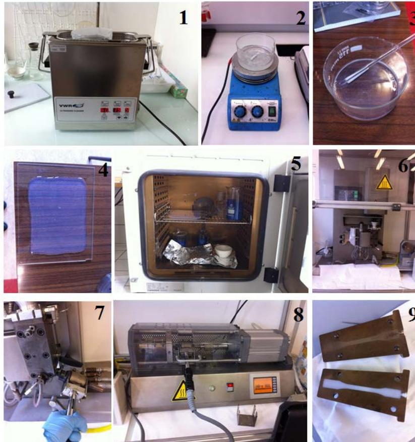
**Figure 2.7 : Les différentes étapes de fabrication des nanocomposites (1 bain-marie et sonification, 2-3 mélange du polymère et nanoparticules avec un barreau magnétique, 4 coulée du mélange en film, 5 séchage du film, 6-8 extrusion et injection, 9 éprouvette).**
