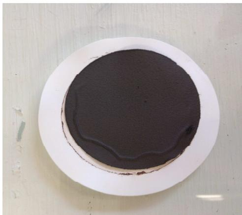
**Figure 3.11 : Electrode flexible sans liant obtenue par filtration des particules sur Buchner.**
