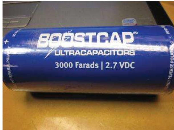
**Figure 1.2 : Supercondensateur Boostcap 3000 F**
