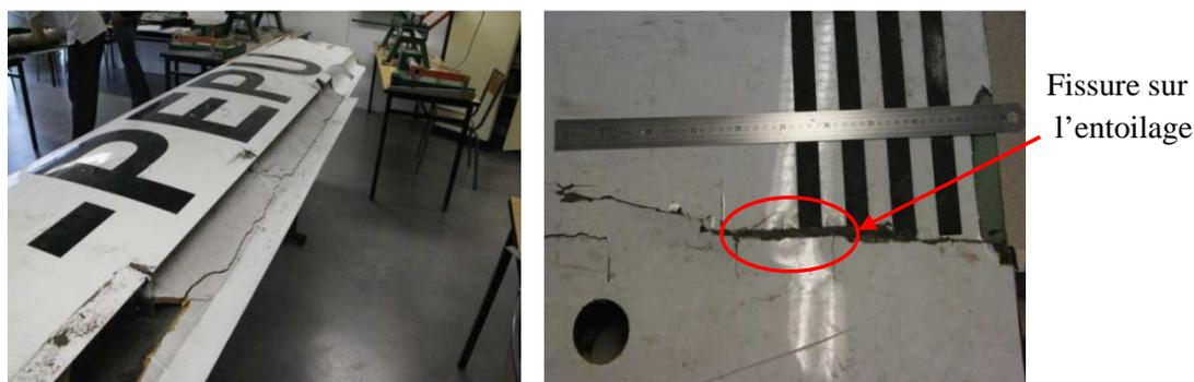
**Figure 3.1** Etat de l'aile accidentée (aile A)
