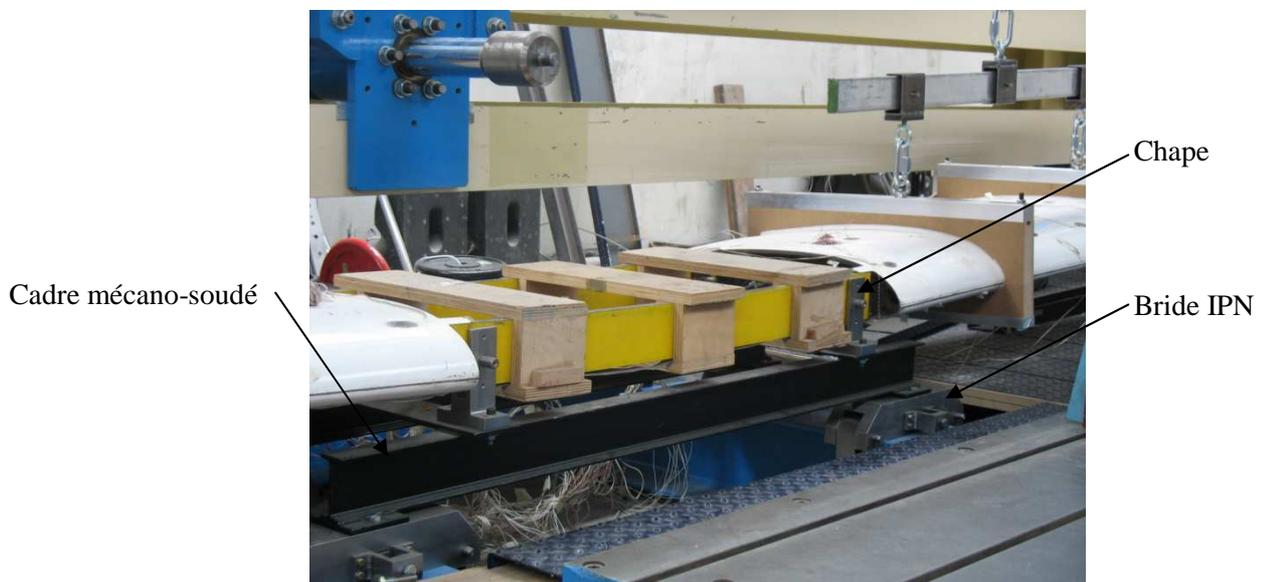
**Figure 3.35 : Fixation de l'aile (endommagée) sur le banc d'essai**
