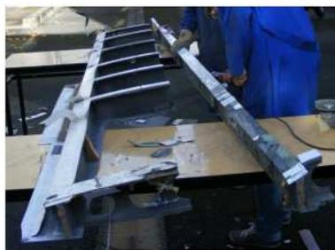
Figure 3.17 : Démontage de l'aile accidentée (aile A)
