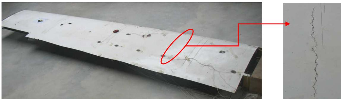
Figure 3.2 Etat de l'aile endommagée (aile B)
