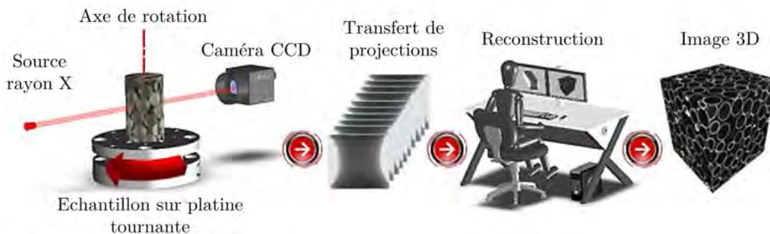
FIGURE 2.9 – Représentation schématique du principe de la tomographie en rayons X [FER 15]
