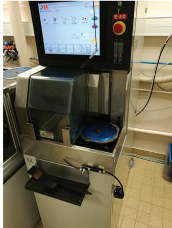
FIGURE 4.20 – Scie à disque Disco DAD 3220 (photographie Ampère)
