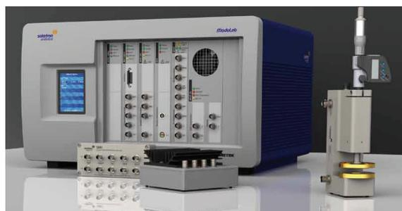
FIGURE 3.12 – Station de tests électriques des matériaux (Solartron Modulab XM MTS)
