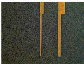
FIGURE 4.11 – Photographie d'un substrat magnétique après développement
