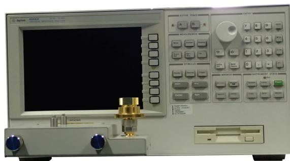
FIGURE 3.9 – Impédancemètre Keysight 4294A avec dispositif de caractérisation de matériaux magnétiques 16454A
