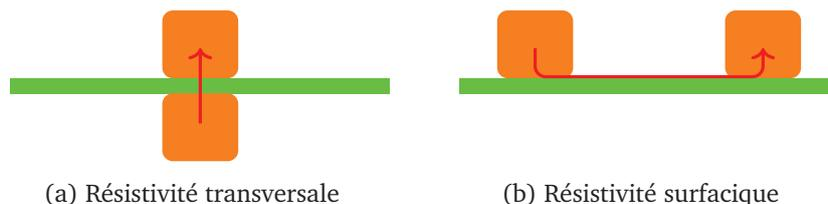
FIGURE 2.11 – Résistivités transversale et surfacique d'un matériau
