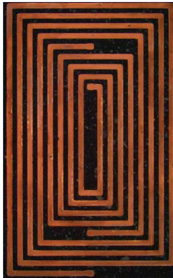
FIGURE 4.19 – Transformateur concentrique sur substrat magnétique isolé après électrodéposition, suppression du film photosensible et des couches d'amorce et d'accroche
