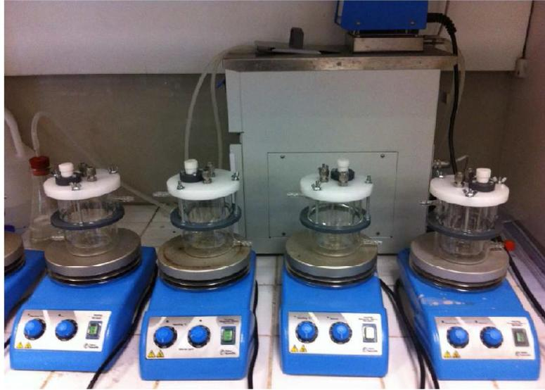
**Figure II.2.** Montage expérimental utilisé pour les tests d'adsorption de U(VI) en système fermé « batch ».
