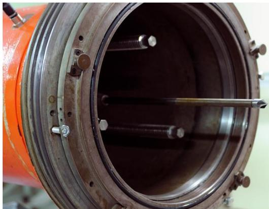
Fig. 93 : Perce-membrane pneumatique
