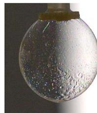
Fig. 150 : Image d'une bulle où paraissent des reflets colorés montrant les différences d'épaisseur du film
