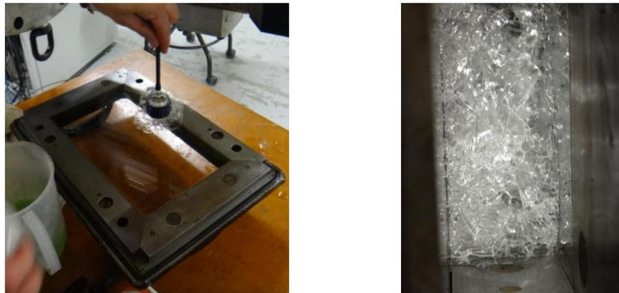
Fig. 97 : Dépôt de la mousse et couche de mousse avant tir vu depuis l'aval de la chambre de mesure.
