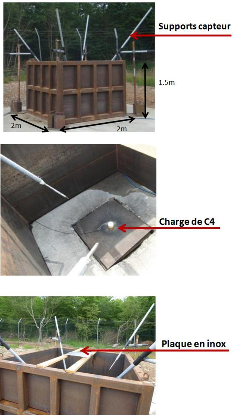
Fig. 57 : Installation expérimentale (présentation du conteneur et emplacement des supports de capteurs et de la charge au centre du conteneur et positionnement de la plaque en inox)
