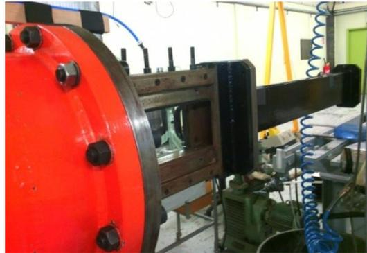
Fig. 92 : Chambre de mesure à section rectangulaire et son prolongement
