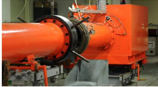
Fig. 91 : Chambre haute-pression associée à un bloc anti-recul et le système de fermeture de type barre à roue entre la chambre haute et basse pression où les membranes sont placées
