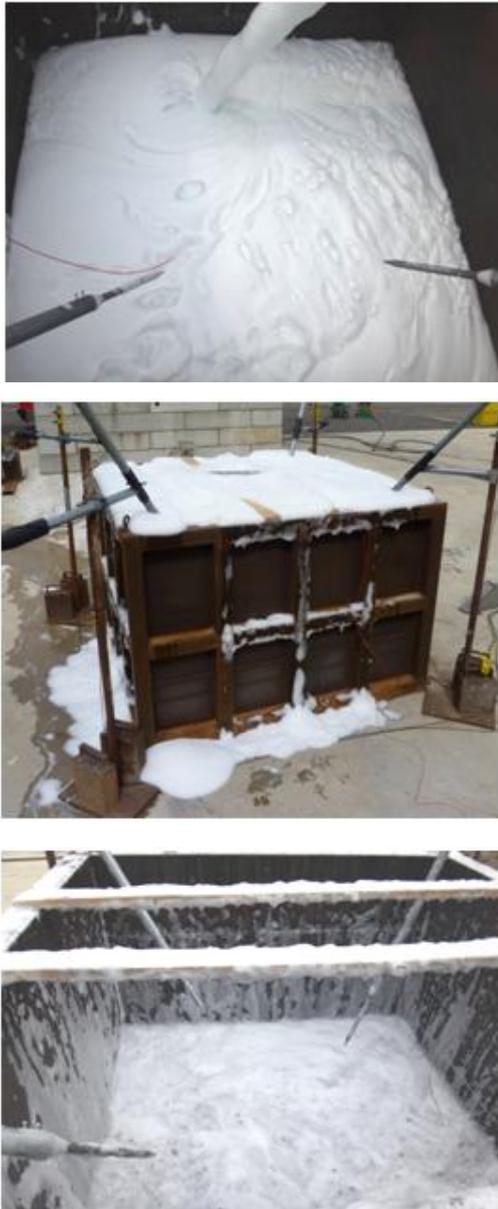
Fig. 68 : Du remplissage du conteneur par la mousse jusqu'à son état final après détonation de la charge explosive
