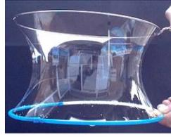
Fig. 16 : Matérialisation d'une caténoïde en film de savon, solution au problème de Plateau (source internet)
