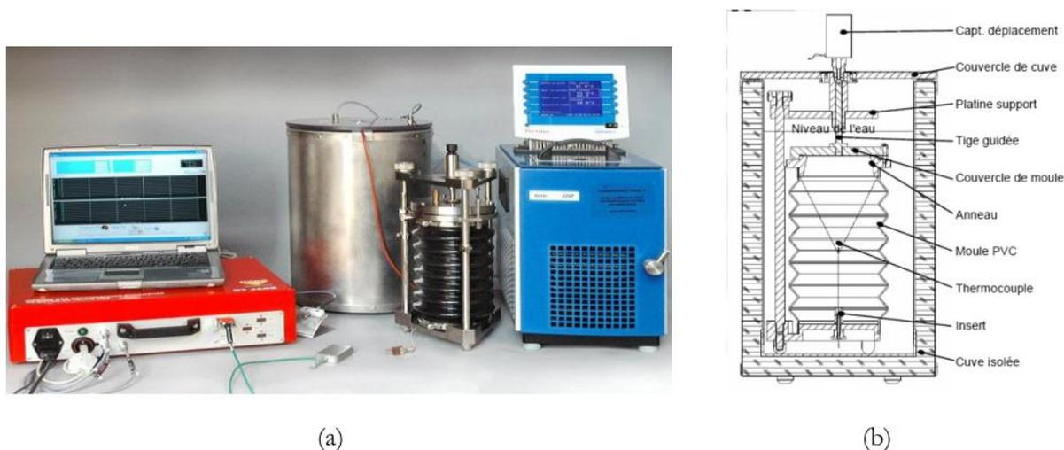
Figure III.1-25 : Banc de mesure du retrait endogène développé par Boulay au LCPC (a) et le schéma du dispositif de mesure (b) [Boulay, 2007].
