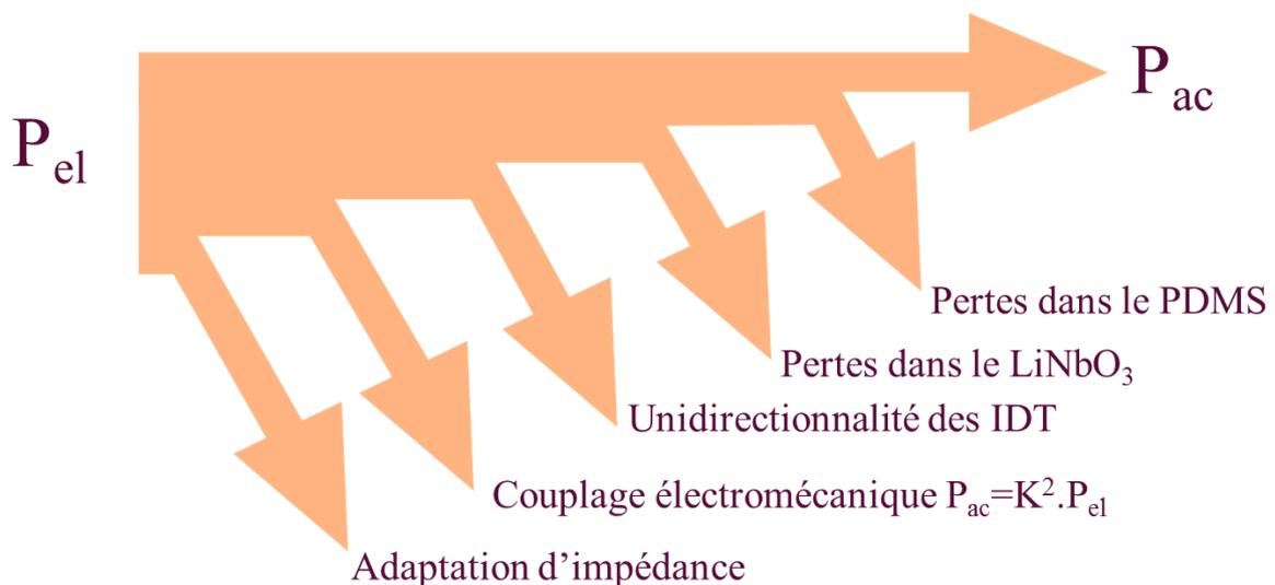
Figure 3.33 - Différentes pertes énergétiques dans une puce acoustofluidique
