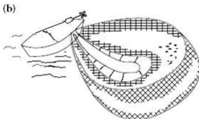
**Figure 6 :** Senne tournante coulissante, (a) Schéma des différentes parties de la senne tournante coulissante, (b) forme de la senne tournante après encerclement. ST : senne tournante ; PA, Polyamide ;  $\epsilon$ , taux d'armement (**E**). (Source Jean Raffray)
