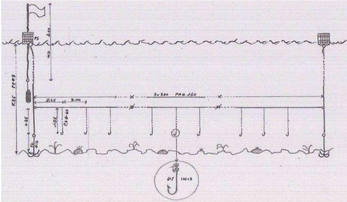
**Figure 8 :** Schéma d'une palangre appâtée. (Source : Jean Raffray)
