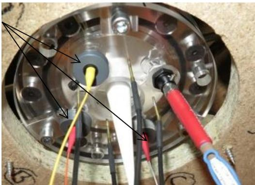
Figure 2.6-32 Implantation des 3 têtes optiques pour la mesure VH sur le montage
