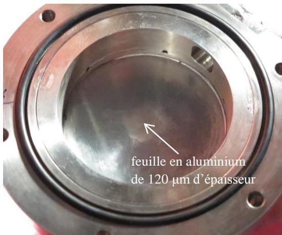
Figure 2.6-3 Collage d'une fine feuille d'aluminium à la surface de l'explosif
