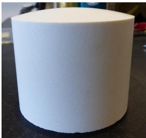
Figure 2.5-12 Bloc d'octoviton de densité 1,86 après usinage
