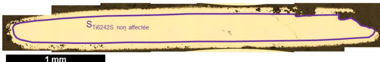
**Figure V-12 : Représentation de la section de métal non affectée par l'oxydation avec NaCl**
