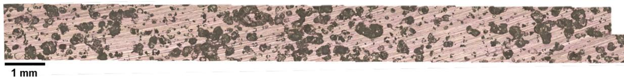
**Figure IV-32 : Observation au microscope optique d'un dépôt de  $1 \text{ mg/cm}^2$  de NaCl**
