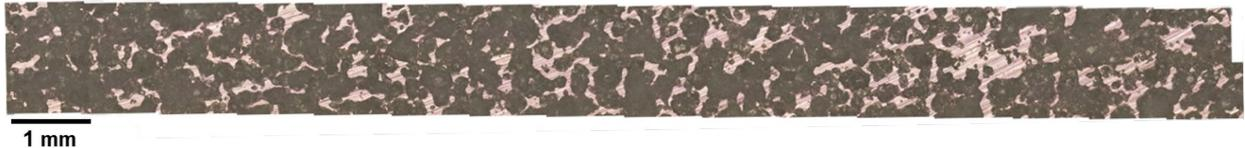
Figure IV-1 : Observation au microscope optique d'un dépôt couvrant de NaCl
