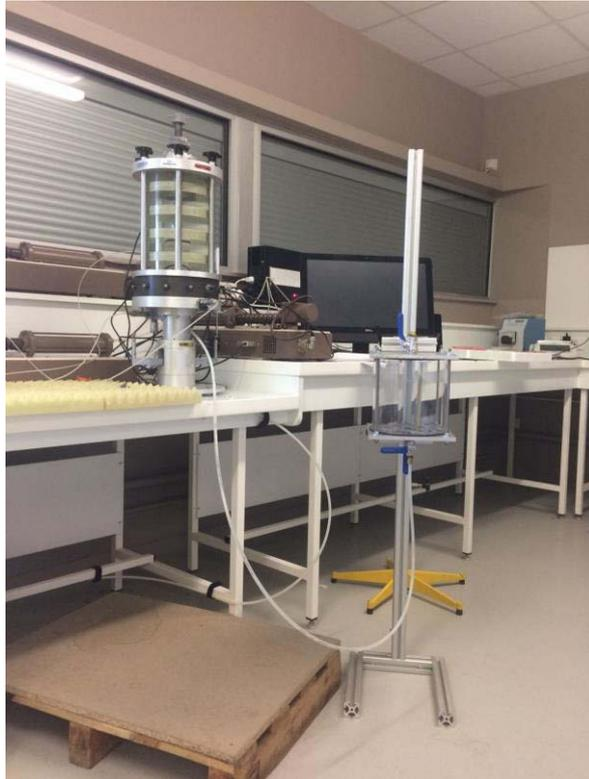
**Figure 62 : Montage complet du triaxial avec la colonne d'eau**
