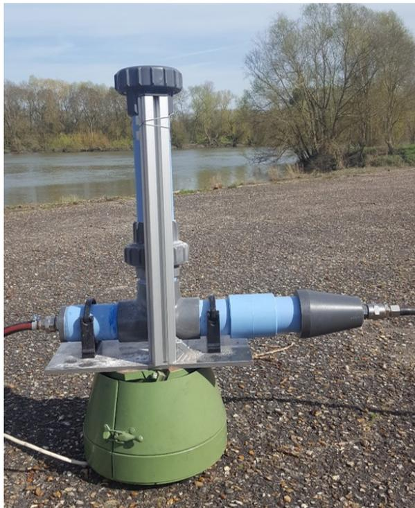
FIGURE 2.22: Ensemeur utilisé pour les essais PIV
