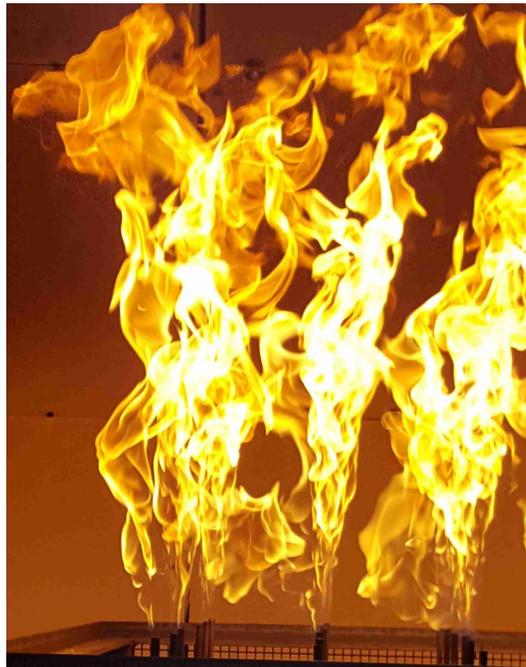
FIGURE 1.6: Flamme turbulentes issues du brûleur Firediag
