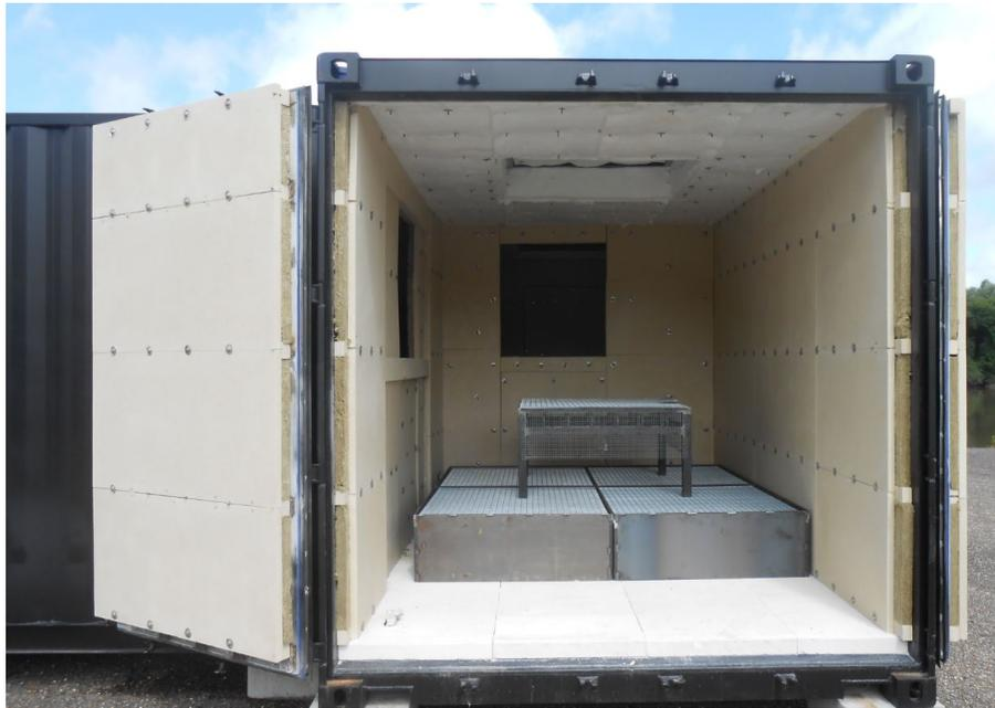
FIGURE 2.4: Isolation de la cellule d'essais
