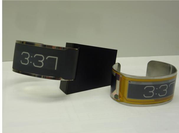
FIGURE 1.10 – La montre CST-01 intégrant une microbatterie EnFilm™. Elle est présentée sur cette photographie avec son module de charge.
