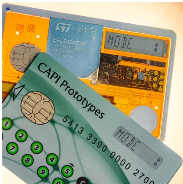
FIGURE 1.8 – Prototype de «Smart Card» intégrant une microbatterie EnFilm™ EFL700AF39.
