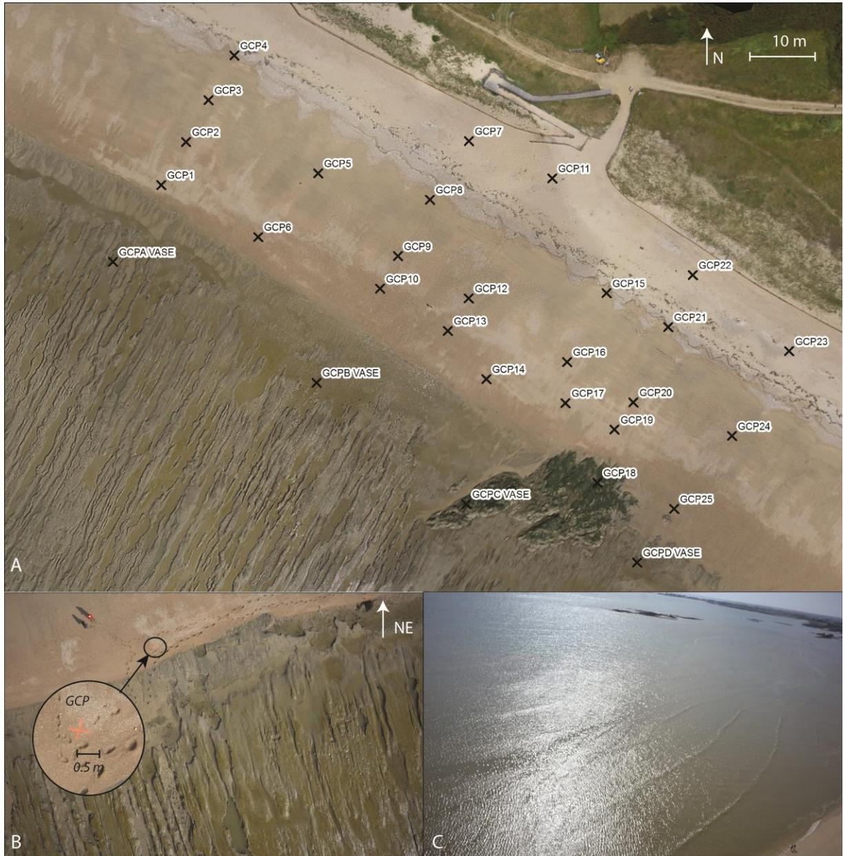
Figure 39. A. Répartition des points de contrôle au sol pour l'analyse photogrammétrique (GCPs- Ground Control Points). B. Image aérienne brute et identification d'un point de contrôle sur la prise de vue. C. Observations des trains de vagues en mode stationnaire.
