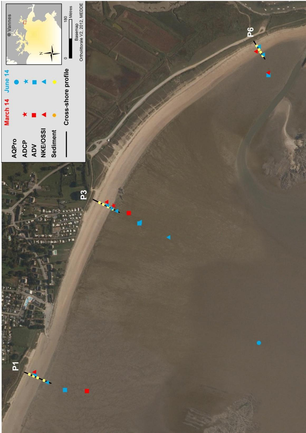
Figure 50. Localisation des différents instruments de mesures hydrodynamiques, des profils topographiques suivis et prélèvements sédimentaires réalisés lors de la campagne de mars et juin 2014 sur la plage de Bétahon
