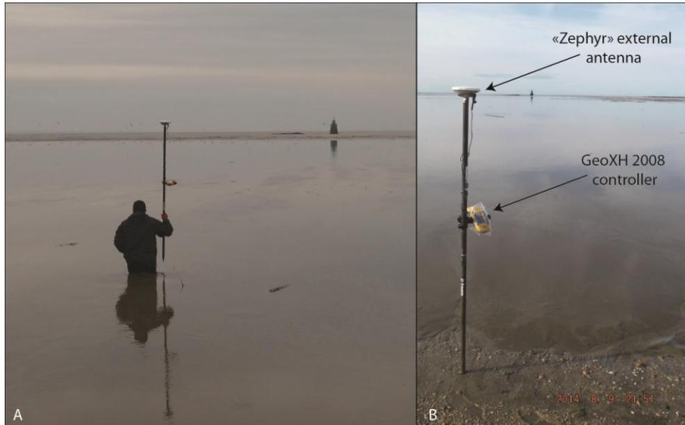
Figure 36. A. Déploiement du DGPS lors d'un suivi topographique sur le platier vaseux de Bétahon. B. Description du système GéoxH série 2008 et son antenne zéphyr externe.
