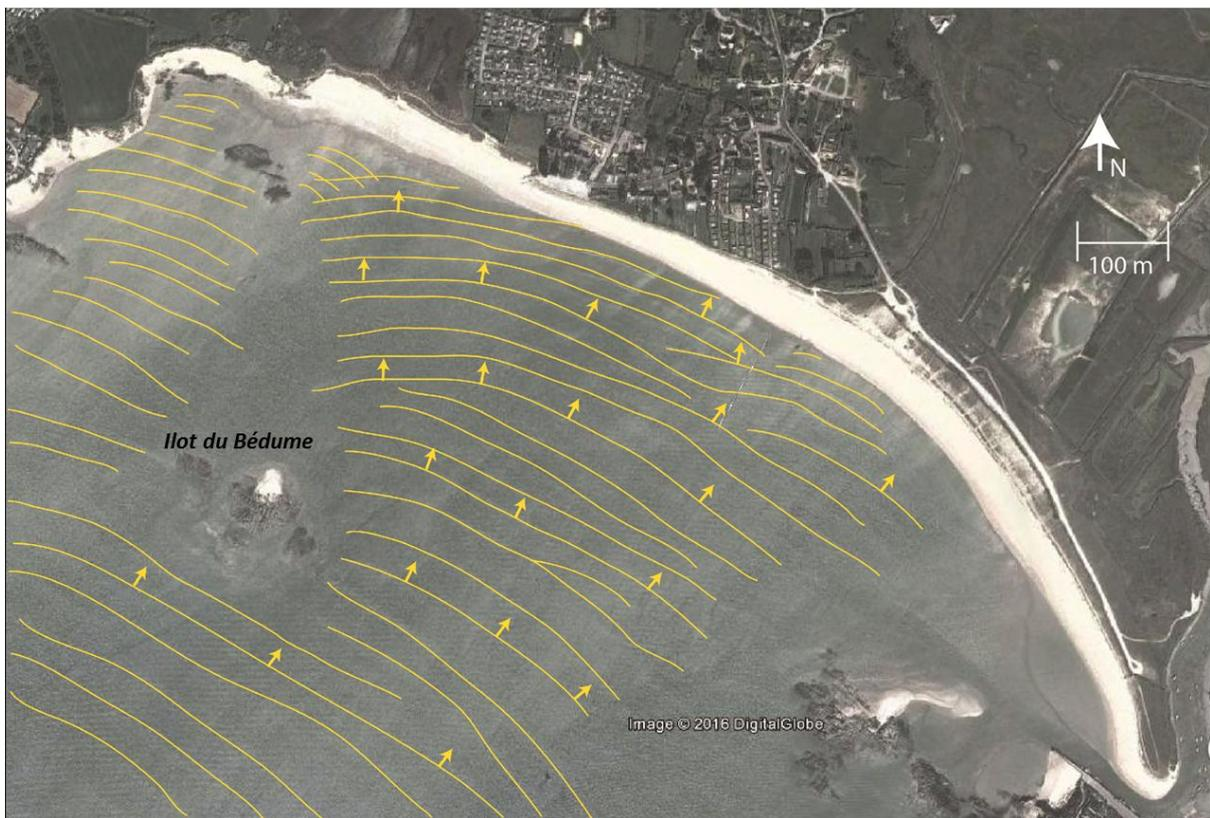
Figure 212. Phénomène de diffraction/réfraction des vagues autour de l'îlot du Bédume du platier vaseux de Bétahon à partir de l'identification des crêtes de vagues sur une image satellite (Google Earth, 2012)
