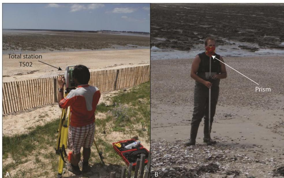
Figure 37. A. Tachéomètre laser Leica TS02 B. Prisme réflecteur.
