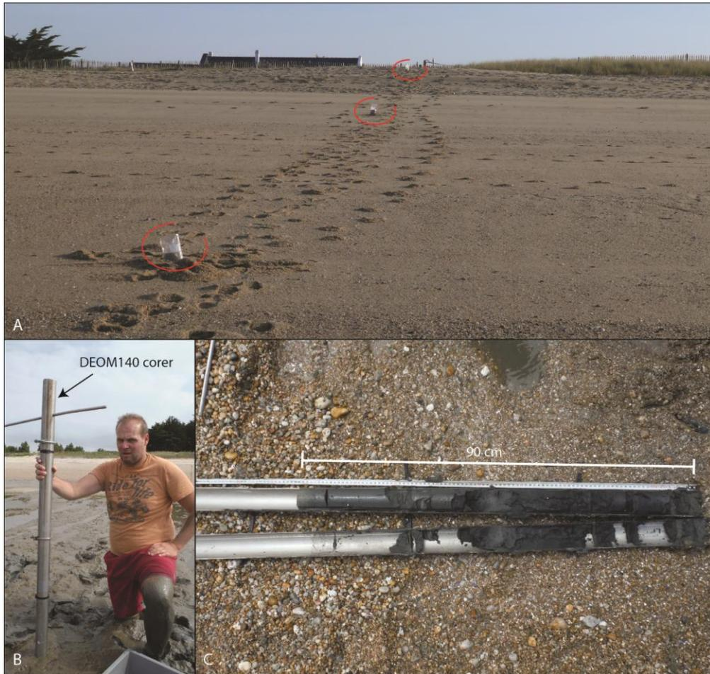
Figure 48. A. Échantillonnage de sédiments non-cohésifs en surface et sub-surface de la zone intertidale de la plage de La Turballe. B. Carottier DEOM140 armé et en déploiement sur le platier vaseux de Bétahon. C. Carrotier DEOM140, post-carrotage, ouvert pour le sous-échantillonnage in-situ.
