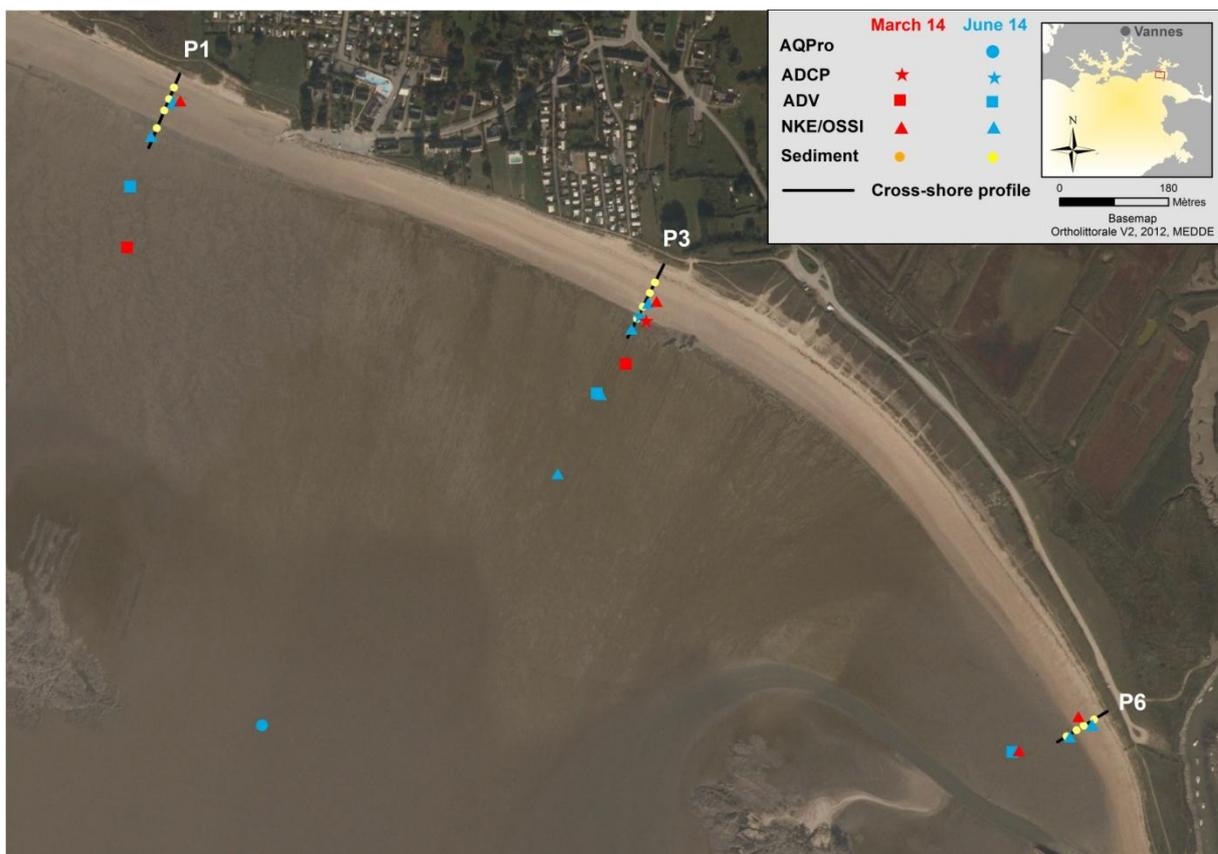
Figure 57. Localisation des instruments de mesures hydrodynamiques, des profils topographiques et des prélèvements sédimentaires réalisés lors des campagnes de mesures de mars et juin 2014 sur la plage de Bétahon.
