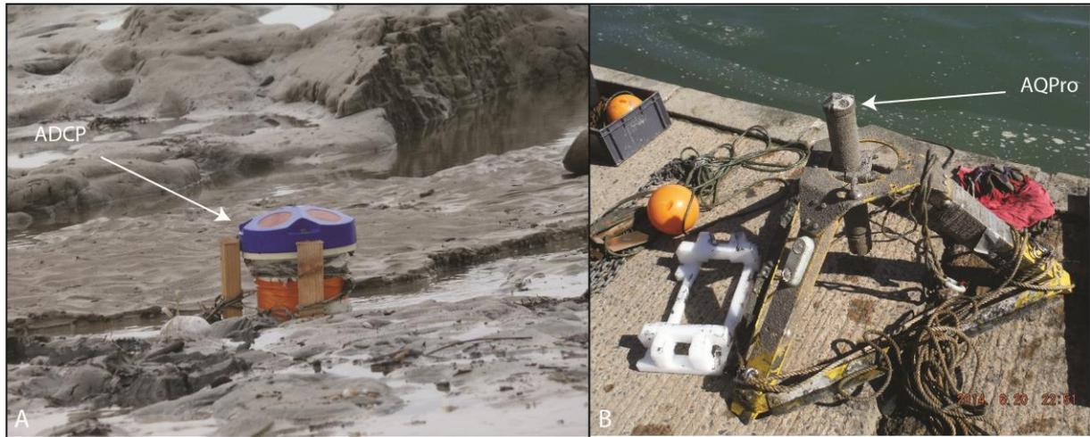
Figure 45. A. ADCP positionné en début de zone dissipative (entre la rupture de pente et la bordure interne du platier vaseux) sur la plage de Bétahon en mars 2014 ; B. AQPro monté sur sa structure tripode et positionné en limite externe du platier vaseux de Bétahon en juin 2014. Notons que 0.5cm de biofouling s'est développé sur le capteur après trois semaines de mesures.
