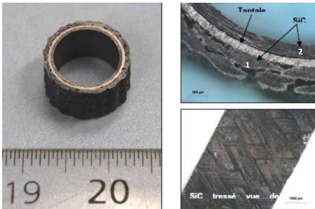
Fig. A1\_1 : Images du concept Sandwich, le SiC est présent dans les couches 1 et 2 entourant un liner métallique, par exemple en Tantale [4].
