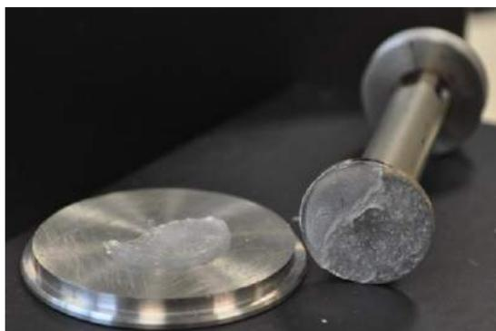
Figure 74 : Echantillon  $Cs_2CO_3$  après avoir été collé à l'entrefer du rhéomètre par ajout de  $D_5$  et équilibré à  $130^\circ C$  pendant 15h
