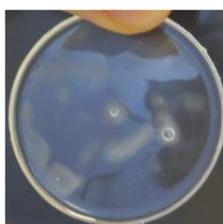
Figure 56 : Formation de bulles au sein d'un échantillon chauffé 6h à 160°C
