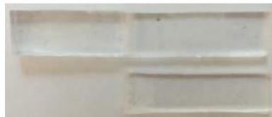
Figure 94 : Assemblage de 2 joints d'élastomère siloxane vivant KOH restés en contact 2h à 130°C après l'expérience de pelage en T.
