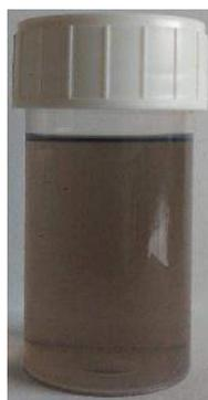
**Figure 13 : Noircissement d'une huile de (méthylhydrosiloxane)-diméthylsiloxane dû à la précipitation du catalyseur de platine**
