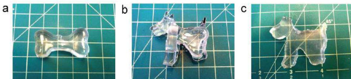
Figure 33 : (a) Un échantillon en forme de dog-bone (b) coupé en plusieurs morceaux et (c) remoulé en forme de chien (90°C pendant 24h) (d'après la référence<sup>9</sup>)
