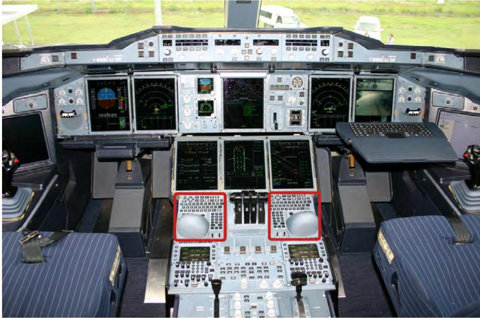
FIGURE 5.9 – Les deux KCCU d'un Cockpit d'A380, crédit : [wikimedia commons, ]
