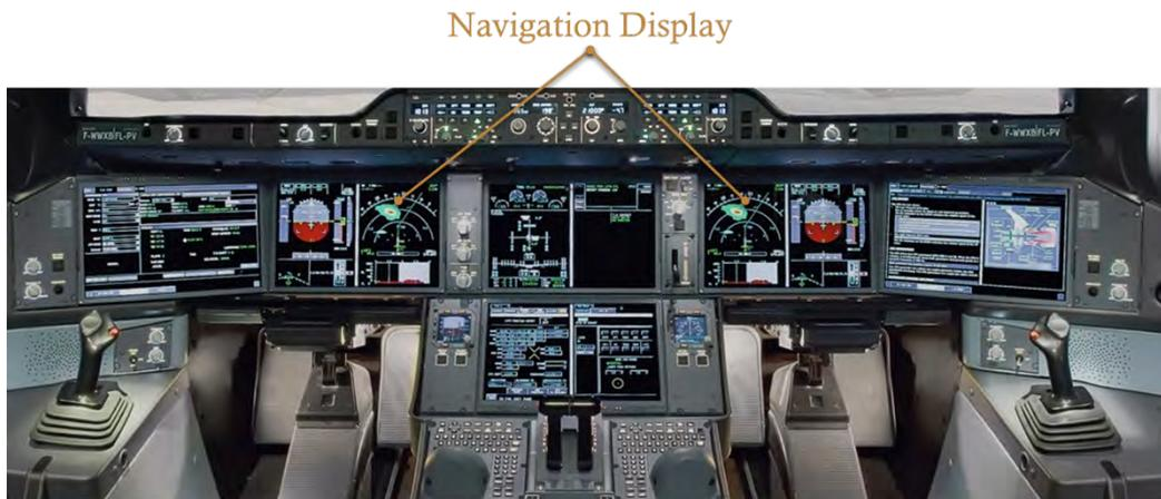
FIGURE 7.1 – Écrans d'un cockpit d'A350, extrait de [Hamon-Keromen, 2014]
