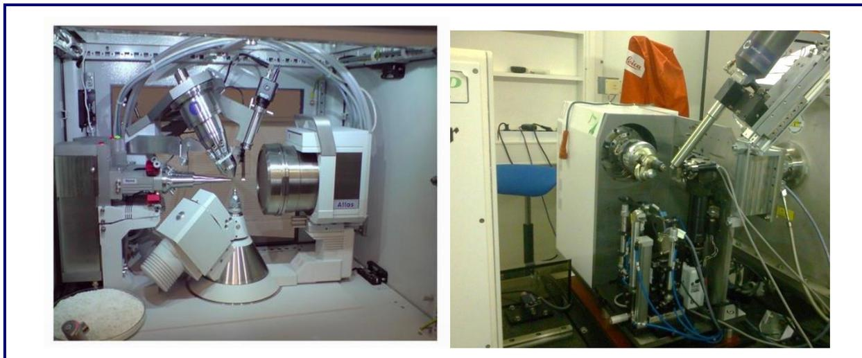
**Figure 34** Diffractomètre Supernova équipé d'un détecteur CCD Atlas (gauche) et dispositif expérimental de la ligne BM30A à l'ESRF de Grenoble (droite)
