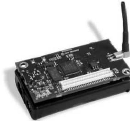
FIGURE 1.2 – Nœud capteur MicaZ [1].
