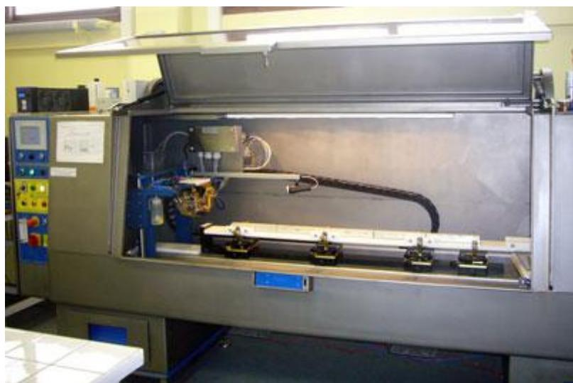
**Fig 4.** Le XRF Core Scanner - AVAATECH du laboratoire EPOC à Bordeaux
